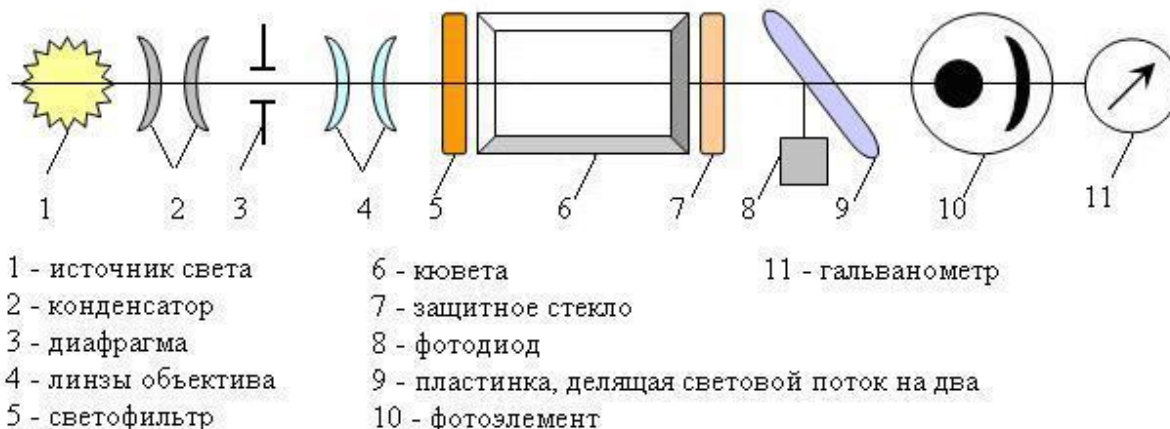
Рис. 11. Оптическая схема фотоэлектроколориметра КФК-2
