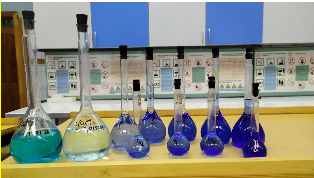
Рис. 16. Растворы солей меди (II) (слева направо): в колбах на 250 мл стандартный раствор 1 ( C(\text{Cu}^{2+}) = 0,1571\text{M} ), стандартный раствор 2 ( C(\text{Cu}^{2+}) = 0,0157\text{M} ), в колбах на 50 мл – растворы калибровочной шкалы (1 – 5), в колбах на 25 мл - контрольные задачи C_{x1} - C_{x4}
